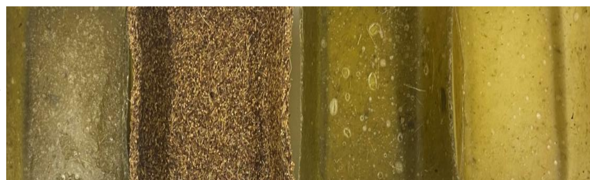
Figura 1. Diferentes formulações de bioplástico utilizando mucilagem de cactos, polpa de celulose, gelatina, cera de carnaúba, glicerol e resíduo de coco.
